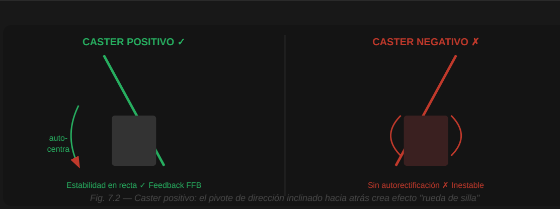
Fig. 7.2 — Caster positivo: la inclinación del pivote hacia atrás crea estabilidad natural en recta (auto-centra) y más feedback en el FFB. El caster negativo elimina ese efecto — el coche se vuelve incontrolable.
