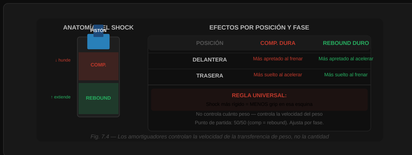
Fig. 7.4 — Anatomía del shock y efectos por posición y fase. Compresión dura = el coche tarda más en hundirse bajo carga. Rebound duro = tarda más en extenderse al quitarse la carga. Nunca cambies 2 shocks a la vez.
