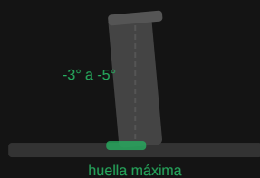
Fig. 7.1 — Camber negativo maximiza la huella de contacto en curva; positivo la reduce
