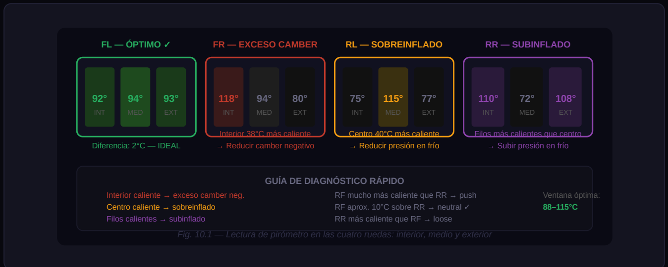
Fig. 10.1 — Lectura de temperatura en las cuatro ruedas. FL óptimo: diferencia de solo 2°C entre los tres puntos. FR: interior 38°C más caliente = exceso de camber negativo. RL: centro sobrecalentado = sobreinflado. RR: filos calientes y centro frío = subinflado.
